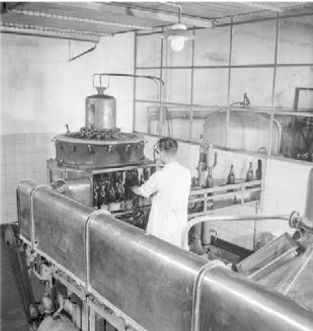
270 Abfüllstation der Mosterei Schlör in Menziken, 1945. In vielen Dörfern ermöglichten Dörranlagen, Mostereien und Brennereien, Früchte und Säfte haltbar zu machen. Einige Betriebe schufen neue Produkte, Schlör im Oberen Wynental etwa erfand 1956 das Erfrischungsgetränk Prego auf der Basis von Milchserum.
