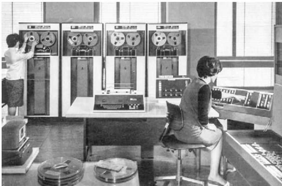
319 Die BBC besass 1964 die grösste und leistungsstärkste Datenverarbeitungsanlage der Schweizer Industrie. Die Operatrice hantiert an der Magnetbändeinheit, die sitzende Kollegin bedient die Technikonssole. Das Unternehmen rationalisierte mit der Anlage die Lohnbuchhaltung.
