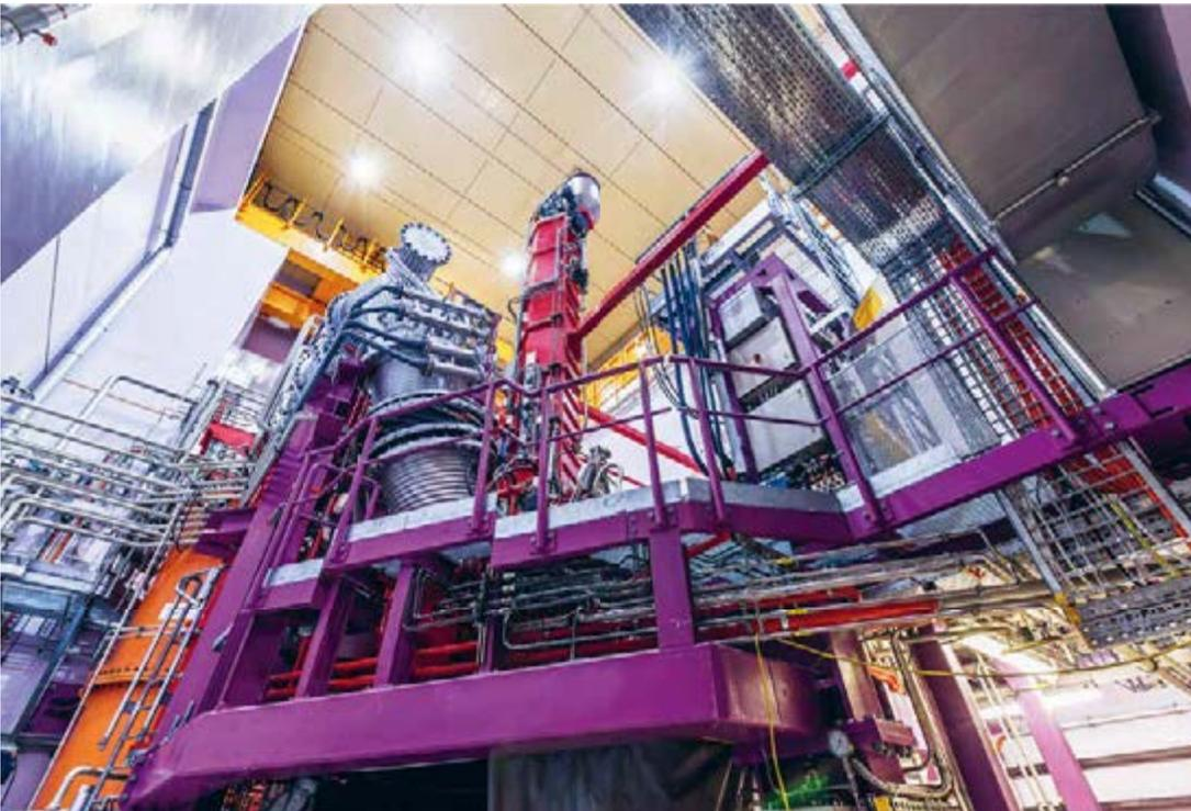
304 Der Plasmaofen im Zwischenlager Würenlingen ist weltweit die erste Anlage, in der leicht radioaktive Abfälle mit einem Hochleistungs-Plasmabrenner bei einigen Tausend Grad Celsius aufgeschmolzen werden. Die Radioaktivität wird durch das Verbrennen nicht verringert, doch das Volumen verkleinert.
