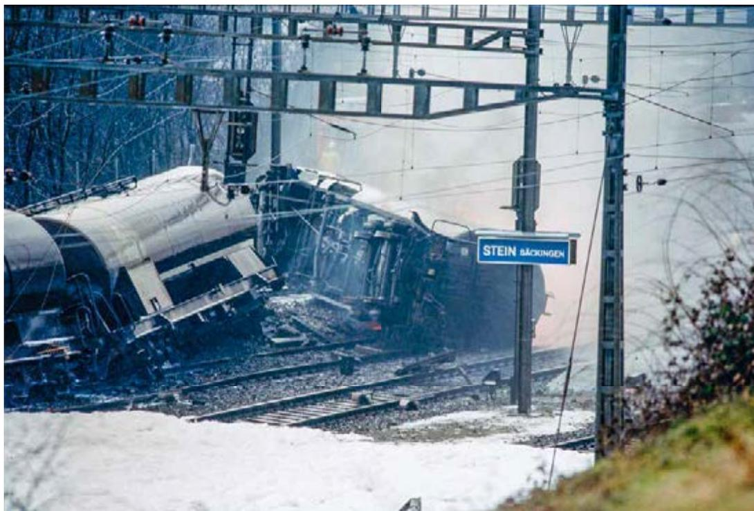
168 Im Bahnhof Stein-Säckingen kam es 1991 zu einem Eisenbahnunglück. Zisternenwagen entgleisten und schlugen leck. Benzin gelangte in die Kanalisation, und es herrschte Explosionsgefahr. Polizei und Feuerwehr leisteten einen grossen Einsatz und sorgten für einen glimpflichen Ausgang.
